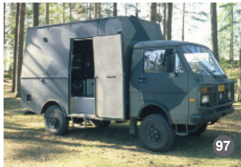
Kuva 97: Maalinosoituskeskus sijoitettiin hyvän liikkuvuuden omaavaan ajoneuvoon. (Kuva: Ilmatorjuntamuseo)
