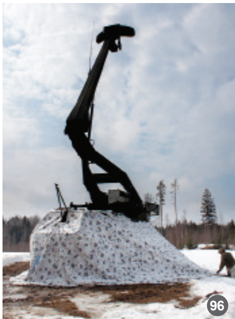
Kuva 96: Maalinosoitustutka 87 mittausasemassa. (Kuva: Salpausselän Ilmatorjuntapatteristo)
