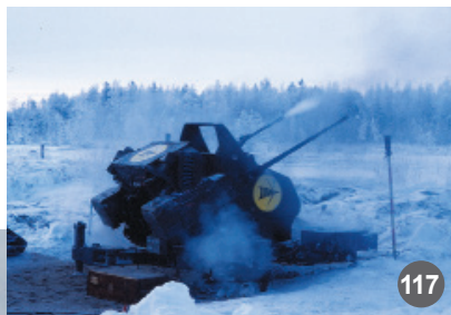
Kuva 116: 20 mm:n Oerlikon-kokeilutykkiä sovitettiin rengaslavetilla kuorma-autoon. Kuva: (Puolustusvoimat)
