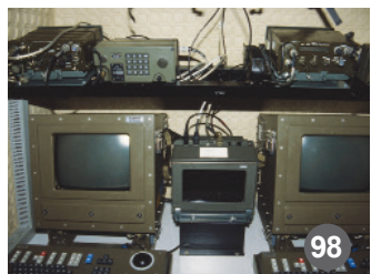
Kuva 100: Nokian valmistama, kosketusnäyttötekniikalla toteutettu tuliasemapääte (TASP) (Kuva: Helsingin Ilmatorjuntarykmentti)
