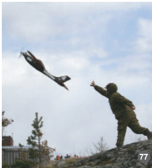
Kuva 77: Male 97 -maalilennokki saatetaan ilmaan. (Kuva: Ilmatorjuntamuseo)
