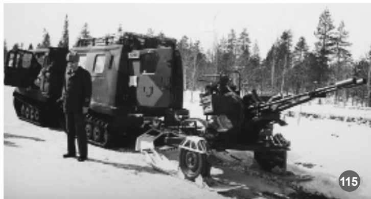
Kuva 115: Liikkuvuuden parantamista testattiin Pohjois-Suomen hangilla vuonna 1986. Kuvassa RovitPston komentaja evl Ahti Lappi ja suksilla varustettu 23 mm ilmatorjuntakanuuna tela-ajoneuvon hinauksessa. (Kuva: Ilmatorjuntamuseo)
