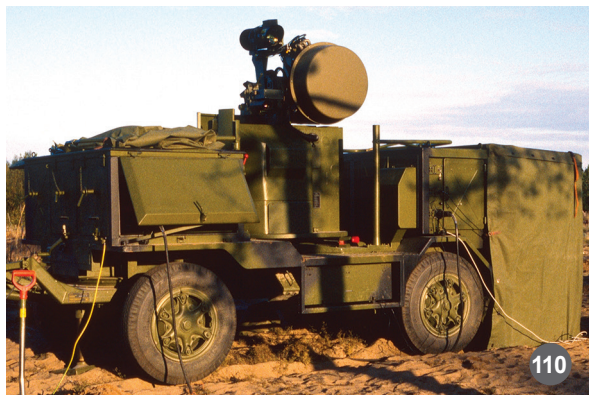
Picture 110: Modernisoitu Super Fledermaus 97-tulenjohtotutka (Kuva: Ilmatorjuntamuseo)
